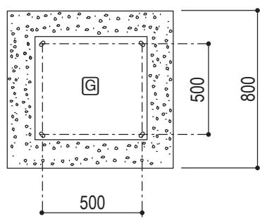
**Kit de Scellement pour Potence Tournante avec Platine 500x500 d'entraxe**
